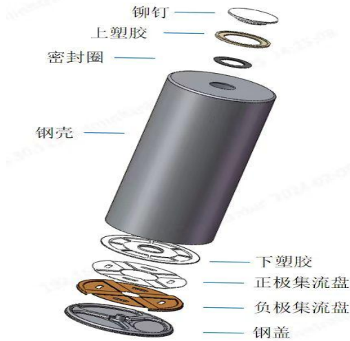
图 2.1-1 圆柱锂电池精密结构示意图
