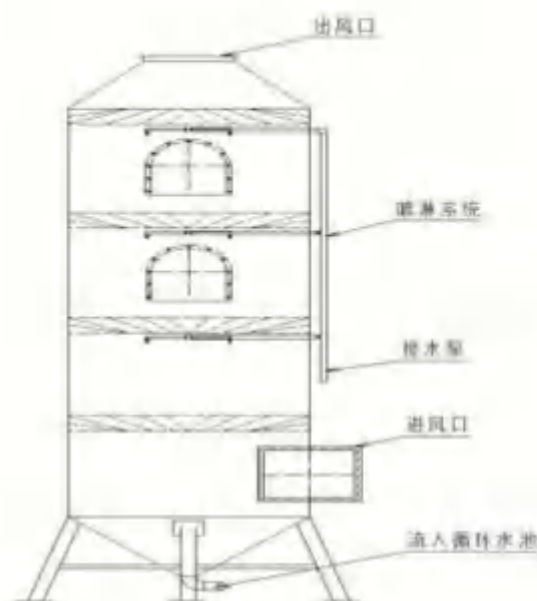
图 4-2 喷淋塔内部结构示意图
