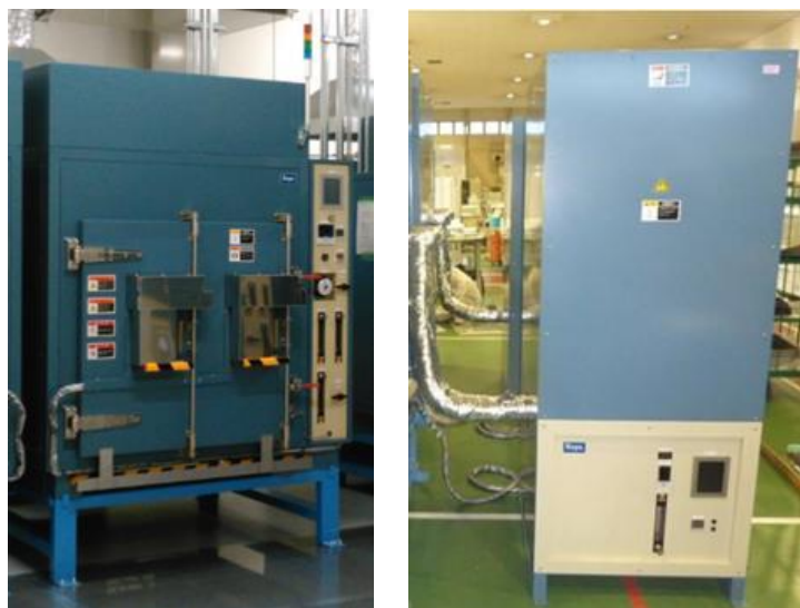
图 4-4 热处理炉以及配套的废气燃烧装置
