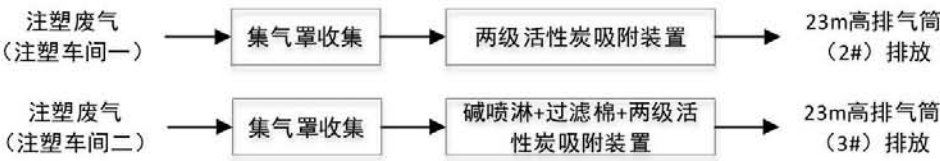
图 4-1 本项目废气处理工艺流程图
