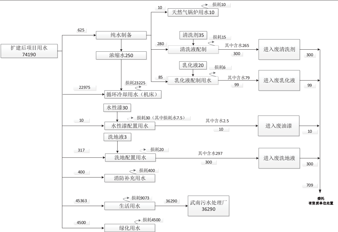
图 2-2 扩建后全厂水平衡图 (m³/a)
