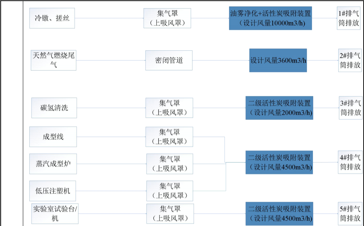
图 4-2 全厂废气处理流程图
