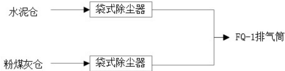
图 4-1 有组织废气处理工艺流程图
