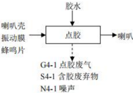
图 2.2-7 喇叭生产工艺流程图
