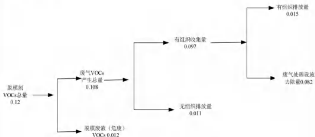
图 2-2 本项目 VOCs 平衡图 (t/a)
