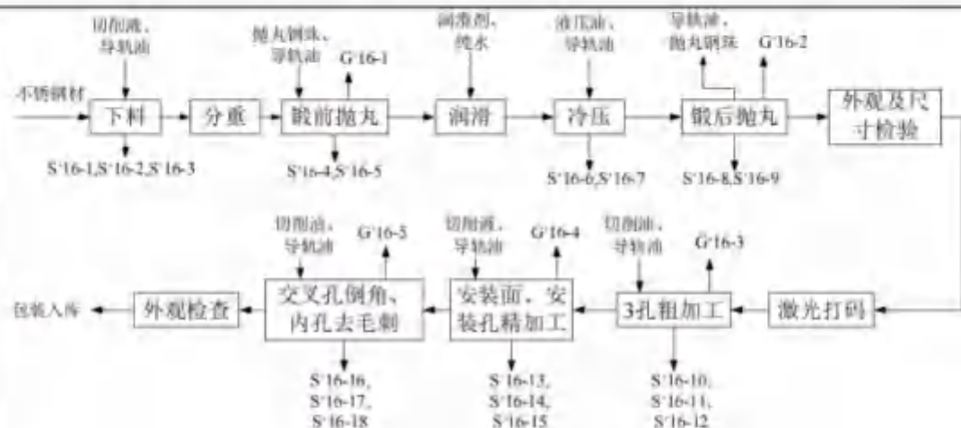
图 2-37 不锈钢泵头生产工艺流程图
