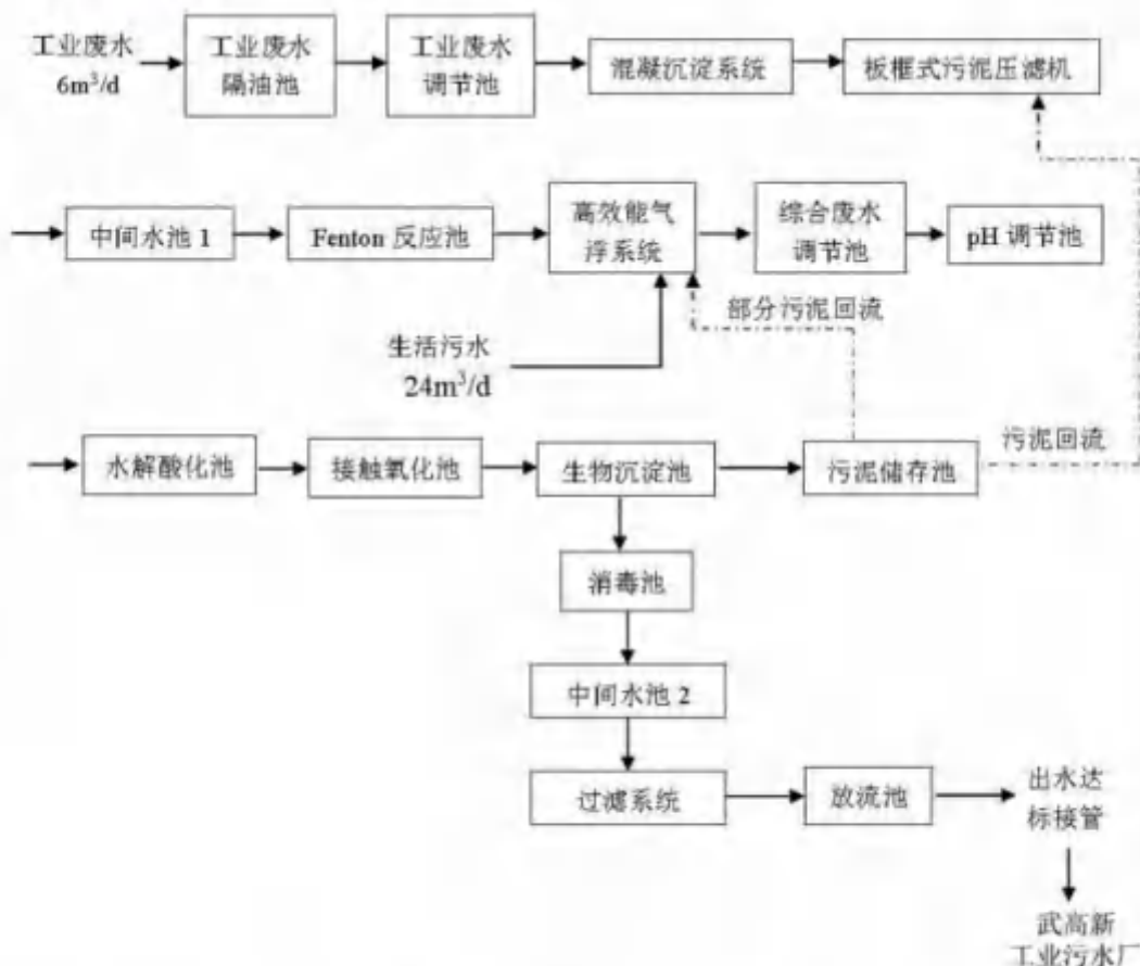
图 4-3 已建 2#废水处理站 (30t/d) 工艺流程图
