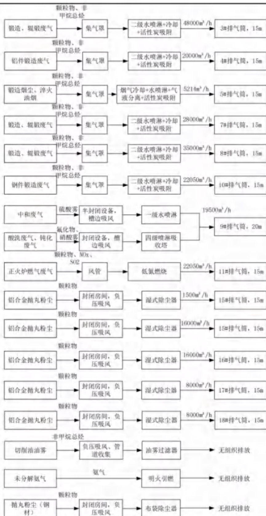
图 4-11 本项目建成后全厂废气收集走向图
