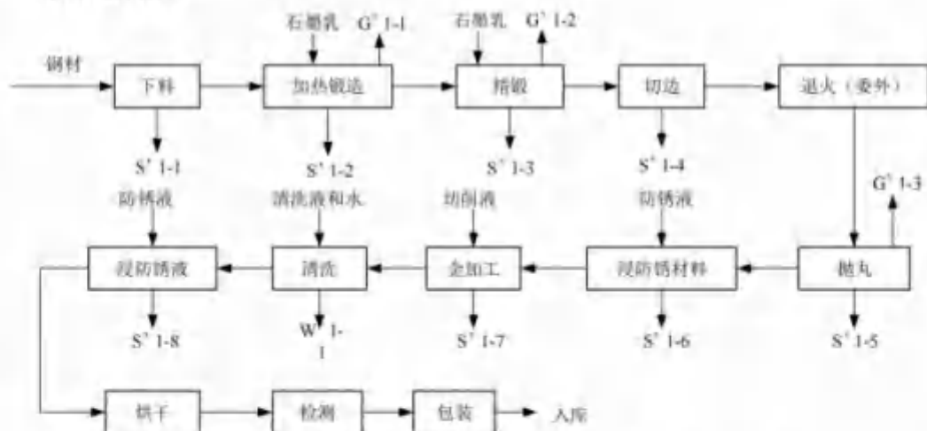
图 2-19 机械零部件精密锻件、电机部件生产工艺流程图
