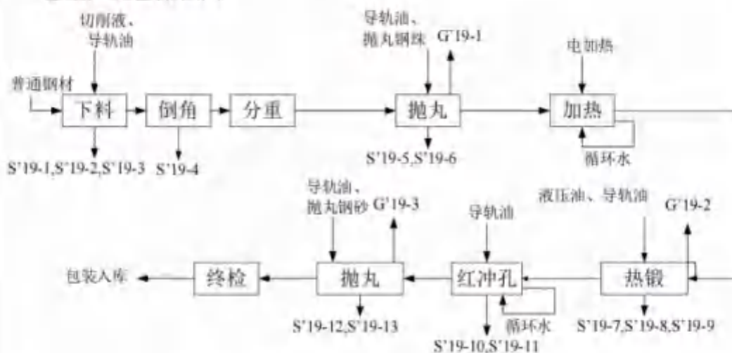
图 2-40 法兰生产工艺流程图
