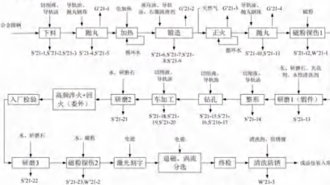
图 2-42 舍费勒变速杆生产工艺流程图
