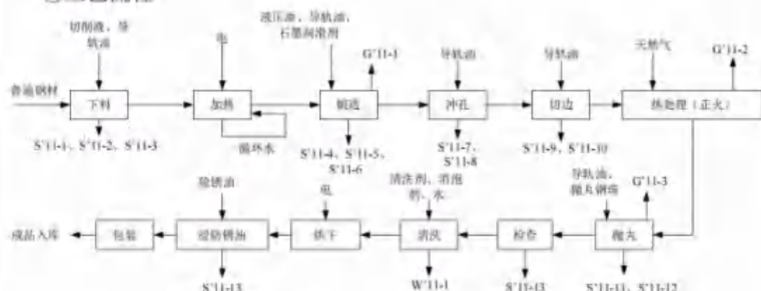
图 2-31 汽车传动系统精锻件（离合器轮毂）生产工艺流程图
