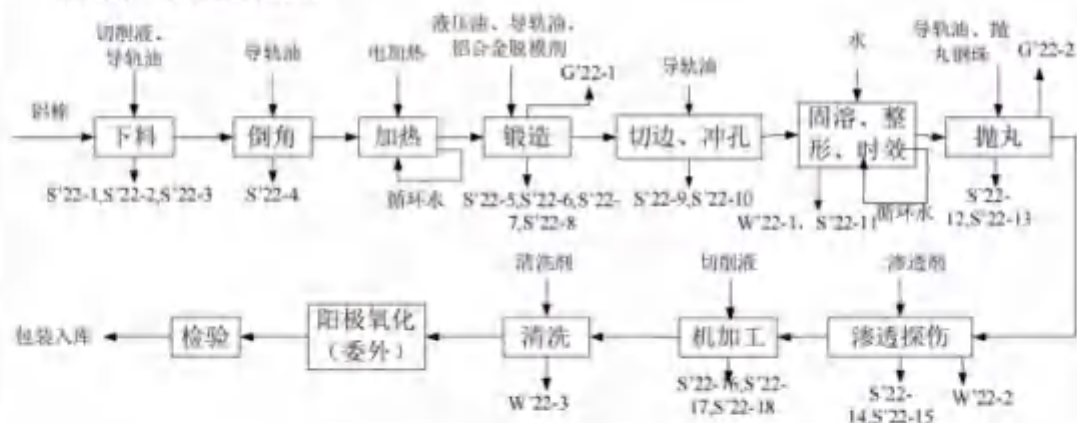
图 2-43 铝合金阀体、轮盘生产工艺流程图
