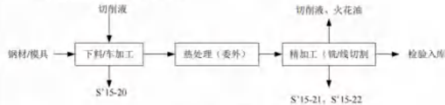
图 2-36 模具生产工艺流程图
