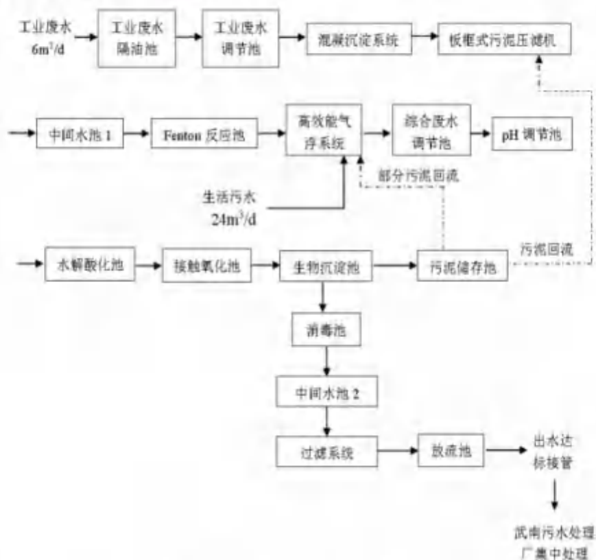
图 2-50 2#废水处理站工艺流程图
