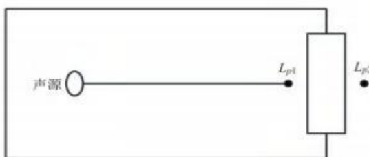
图 4-1 室内声源等效为室外声源图例
