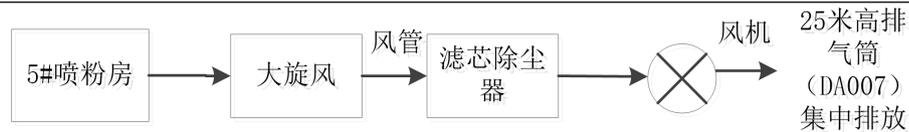
图 4-7 3#喷粉粉尘收集及处理工艺示意图
