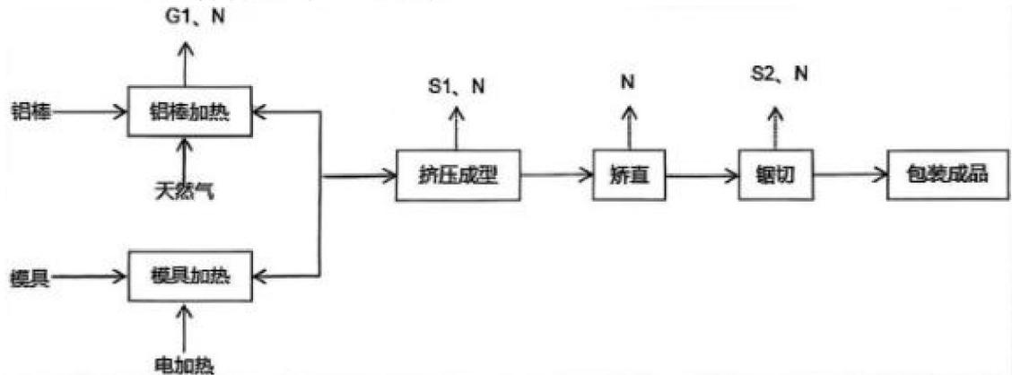
图 2-4 铝型材制品工艺流程图
