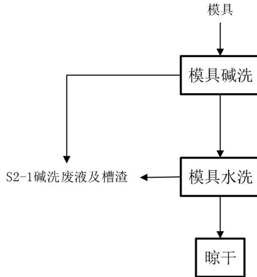
图 2-4 模具碱洗工艺流程图
