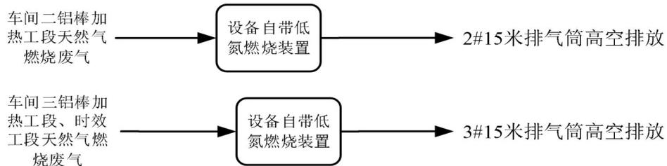
图 4-1 本项目废气处理工艺流程图
