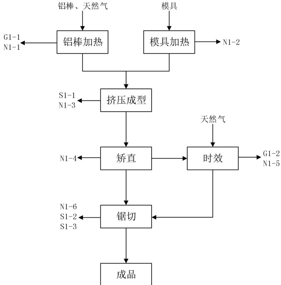
图 2-3 石油工程机械换热器零部件生产工艺流程图
