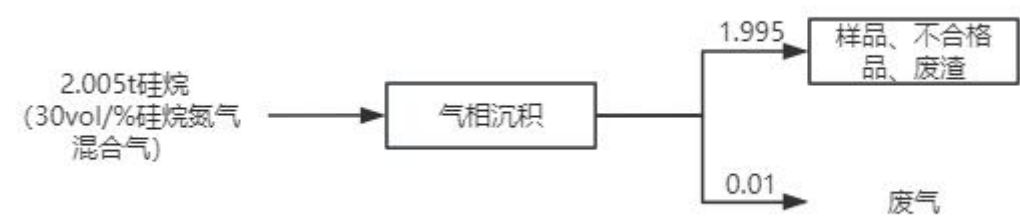
图 2-3 本项目硅烷平衡图 (t/a)
