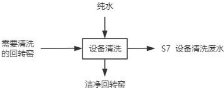
图 2-9 回转窑清洗工艺流程图
