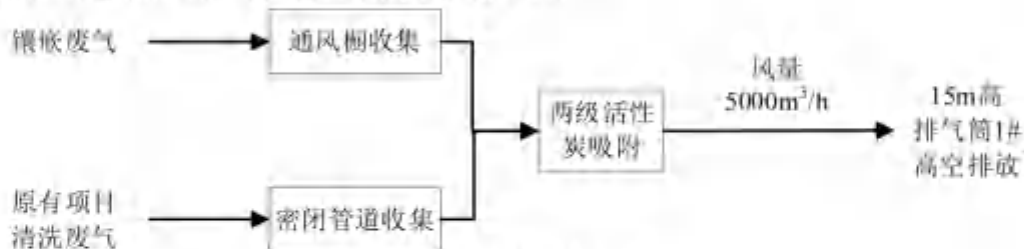
图 4-1 全厂废气收集方式
