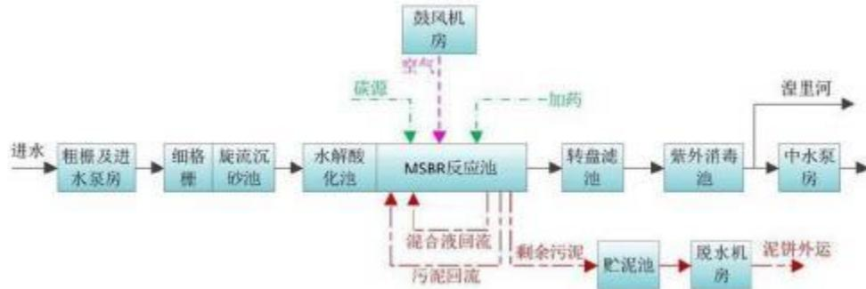
图 4-1 湟里污水处理厂污水处理工艺流程图
