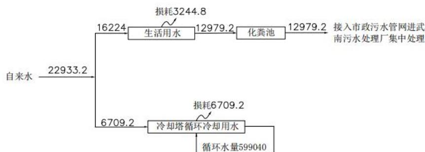
图 2-1 本项目水平衡图 (单位: t/a)
