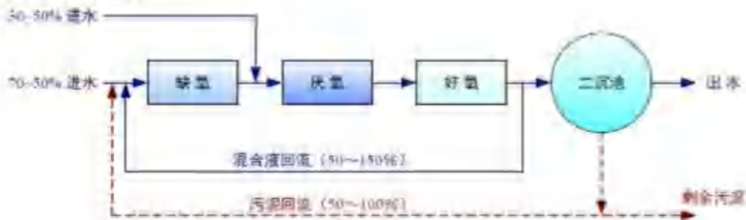
图 3.4-2 多点进水倒置 A/A/O 工艺流程图
