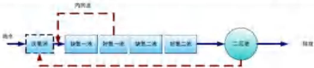
图 3.4-4 Bardenpho 工艺流程图
