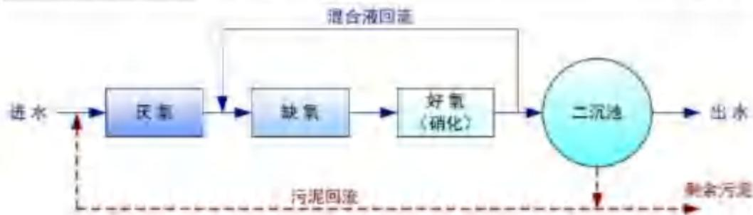
图 3.4-1 A/A/O 工艺流程图
