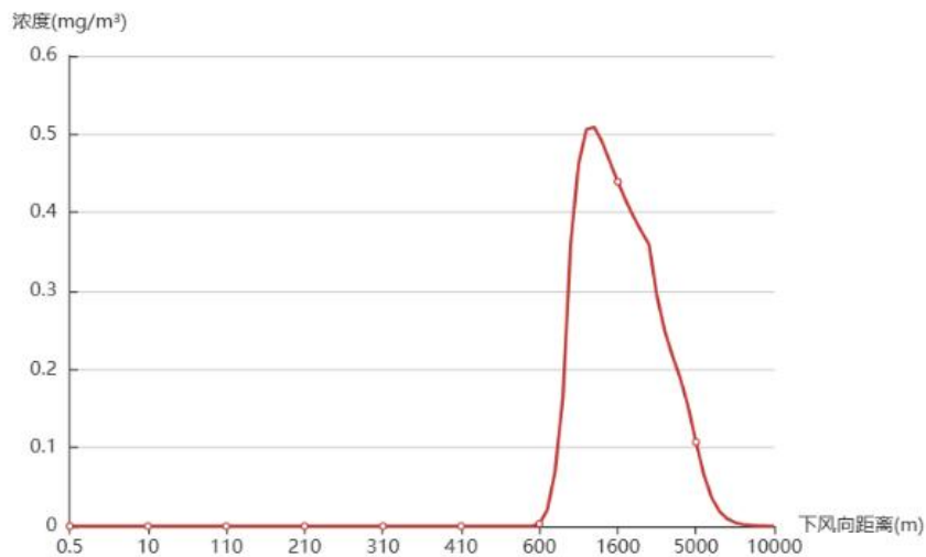
图 7.1-3 下风向不同距离处 CO 的最大浓度值（最不利气象条件下）
