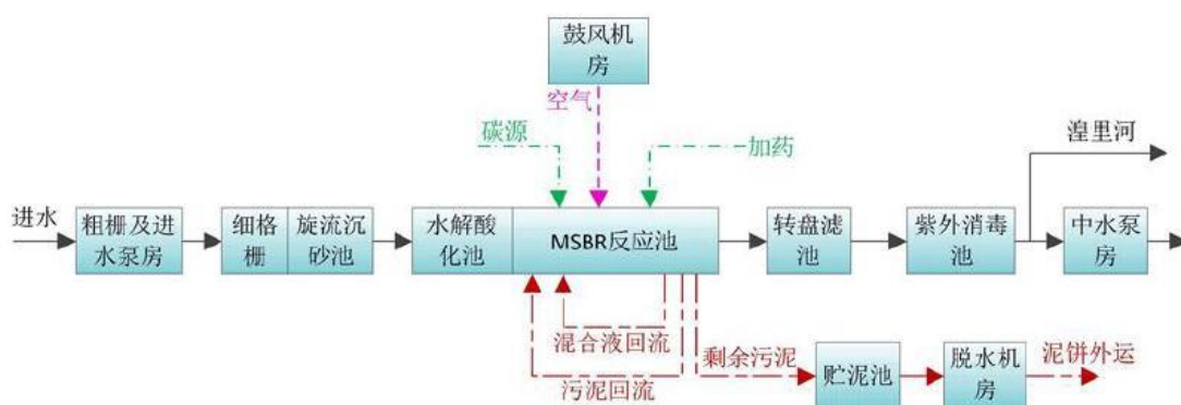
图 4-1 湟里污水处理厂污水处理工艺流程图
