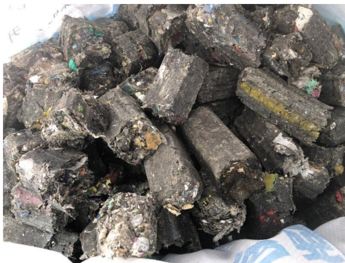
图 2-1 RDF 燃烧棒产品示例图
