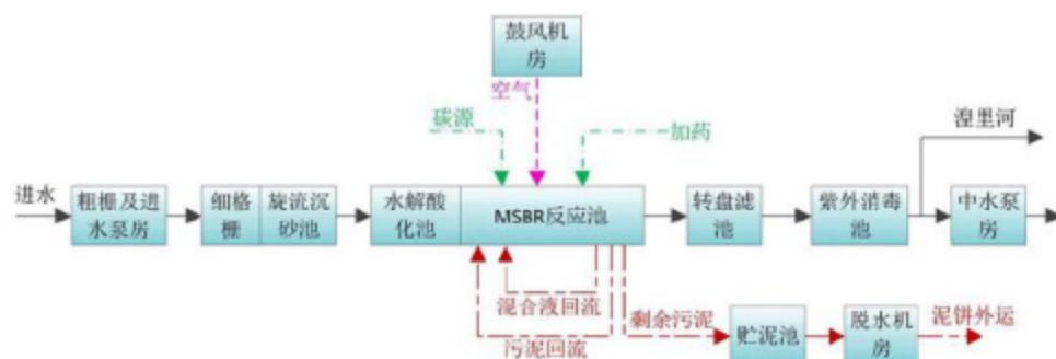
图 4-2 湟里污水处理厂污水处理工艺流程图
