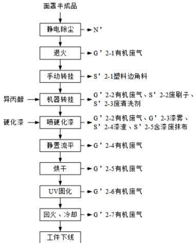
图 2-6 PC 硬化喷涂工艺流程图
