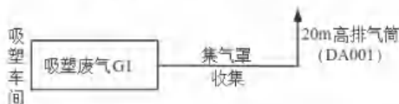
图 4-1 本项目废气处理走向图
