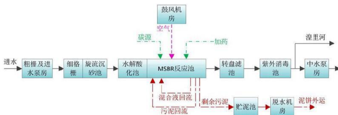
图 4-2 湟里污水处理厂工艺流程图
