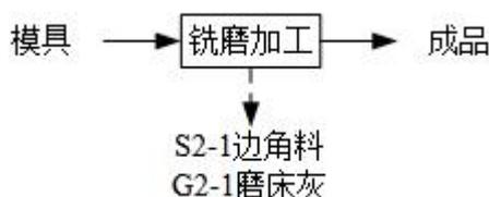
图 2-4 模具维修工艺流程图
