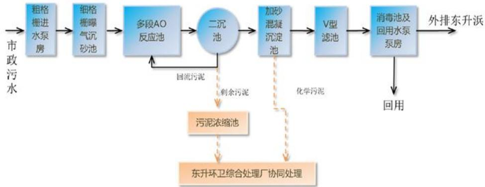
图 2-8 常州市武进区阳湖生态净水厂污水处理工艺流程图
