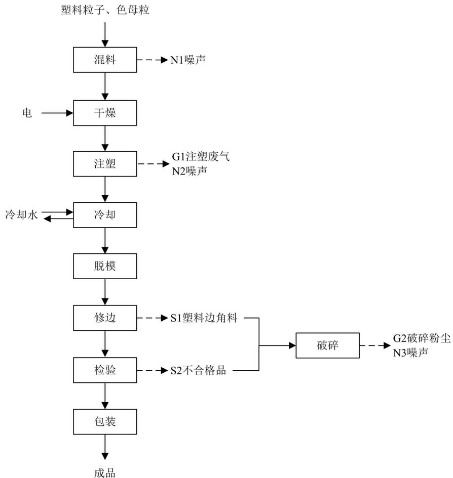
图 2-2 园艺杆塑料零配件生产工艺流程图
