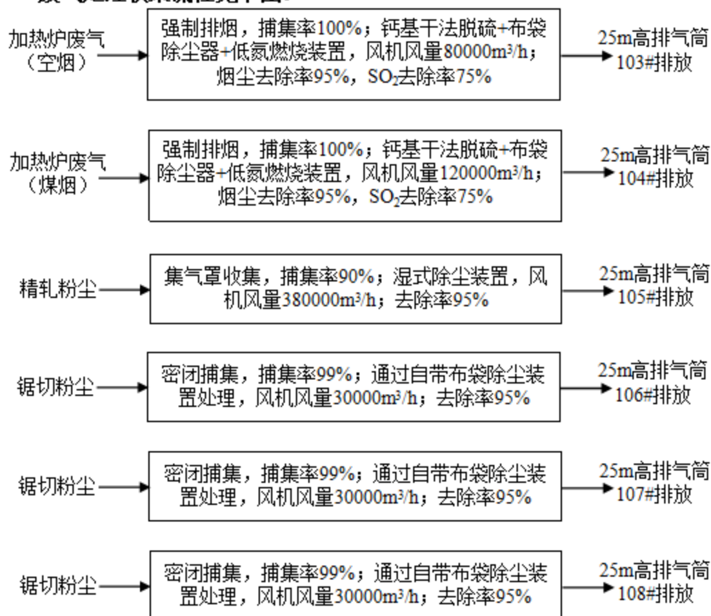
图 4-6 废气处理收集流程图
