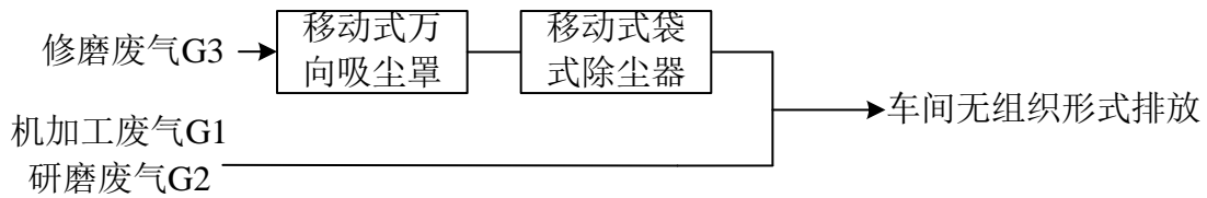
图 4-1 本项目废气收集及治理措施
